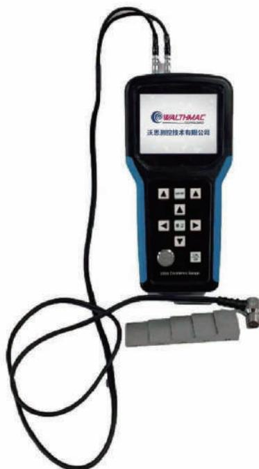
ULTRAMAC-H系列超声波精密测厚仪是一款带A/B扫描的新型手持式高精度数字超声波测厚仪，采用脉冲反射超声波测厚原理，适用于能使超声波以一恒定速度在其里面传播，并能从其背面得到反射的材料厚度的测量。测量分辨率达0.001mm，测量范围薄至1mm(塑料)。
